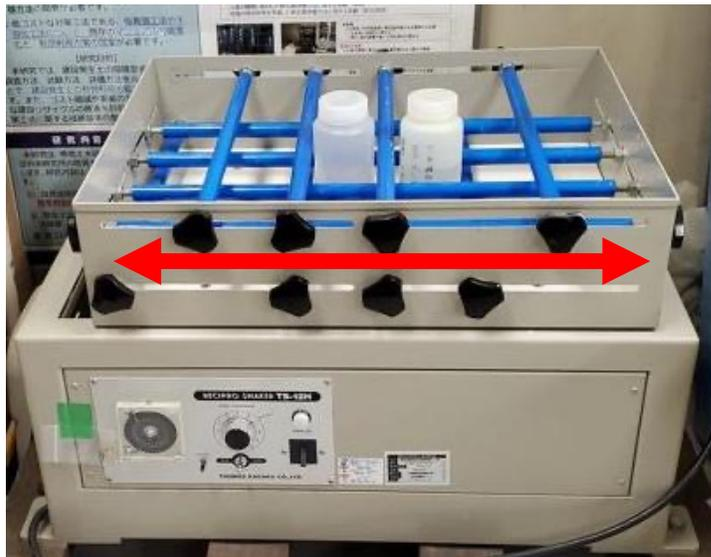
短期溶出試験（環告18号の溶出試験に準拠）
